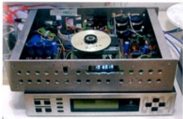
一見して、ピックアップのメカ部を除きすべて自作とわかるCDプレーヤー。送り出しに真空管バッファを装備しているようだが、これだけの回路をよくシャシー内に収めたものだと感心する
