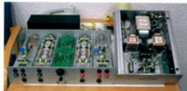
左はフォノイコライザーだが、シャシーの構造がおもしろい。前後のパネル間を10本の鉄支柱(?)で支え、中央に電源基板。その左右に各チャンネル増幅器を配置した構造。右はKT88と思われるパワーアンプの内部。シャシー内に出カトランスを収容している
