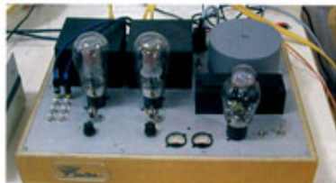
メッシュプレートの中製ナス型300Bを使用したシングルステレオパワーアンプ。トランス類はいずれもケース入りだが、見慣れない色と形でブランド名の記載がどこにもない。これも手製のケースでは?
